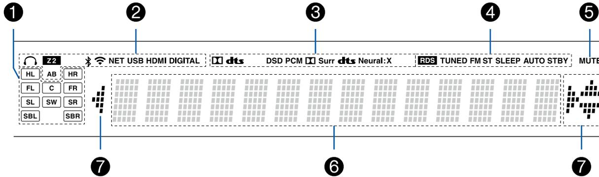
1. Visualización de altavoz/canal: Muestra el canal de salida que corresponde al modo de escucha seleccionado.
