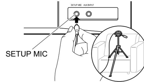
Para colocar el micrófono de configuración de altavoz en un trípode, consulte la ilustración.
