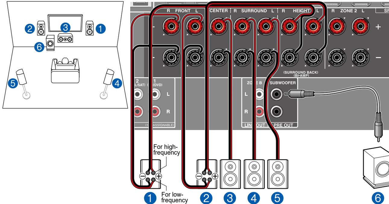
Es posible configurar un sistema de canales 5.1 (→p19) conectando altavoces delanteros que admitan la conexión de bi-amplificación. La conexión de bi-amplificación puede modificar la calidad de los rangos graves y agudos. Asegúrese de retirar el puente que conecta los conectores del woofer y los conectores del tweeter de los altavoces de bi-amplificación compatibles. Consulte, también, el manual de instrucciones de los altavoces.
