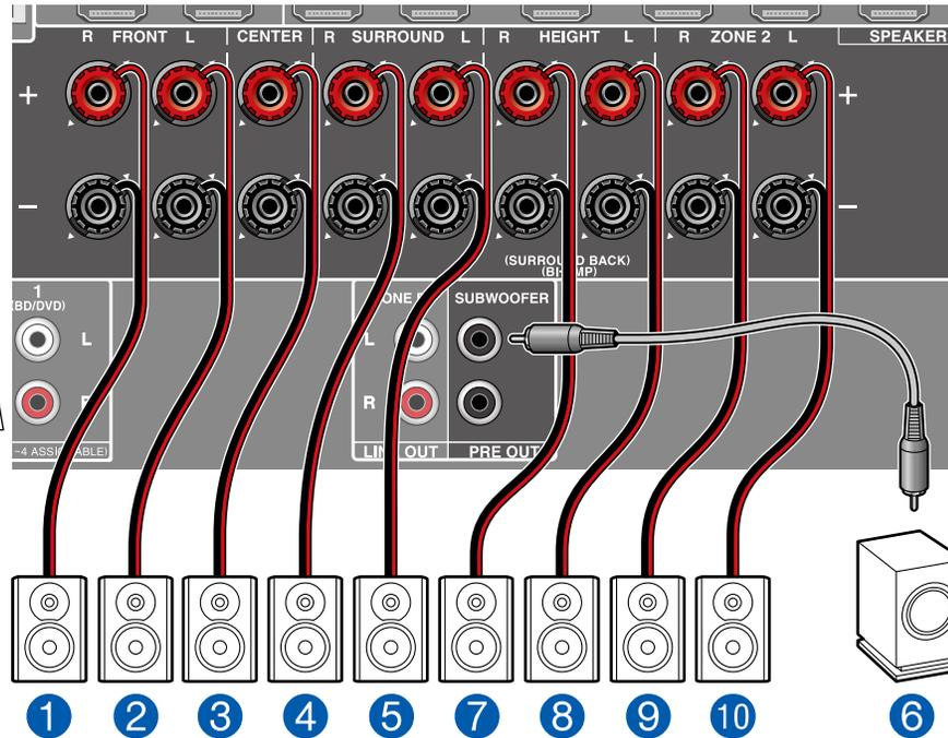
**MAIN ROOM:** Este es un sistema de canales 7.1 que incluye el sistema básico de canales 5.1 y unos altavoces envolventes traseros adicionales. Para obtener información detallada acerca de la disposición de los altavoces, consulte "Instalación de altavoces" (→p20).
