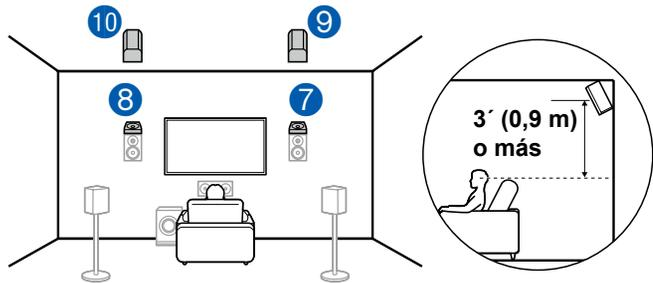
El ancho entre los altavoces altos traseros debe coincidir con el ancho de los altavoces delanteros y deben instalarse a una altura mínima de 3' / 0,9 m con respecto a los altavoces delanteros y se inclinan hacia la posición del oyente.
