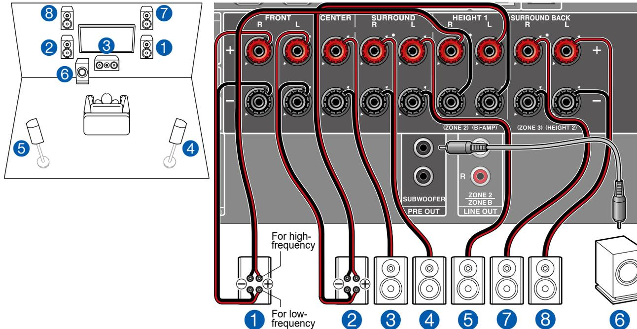
Esta es una combinación del sistema de canales 5.1 y altavoces altos delanteros. Un altavoz alto delantero es un tipo de altavoz de altura. Puede seleccionar únicamente un conjunto de altavoces de altura entre los siguientes tres tipos de conexión.
