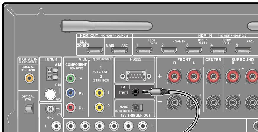
Cuando conecte una unidad receptora de mando a distancia que tenga un receptor de infrarrojos a esta unidad, es posible el uso del mando a distancia aunque su señal sea difícil de alcanzar (debido a la instalación en el armario, etc.) También puede operar la unidad utilizando el mando a distancia desde una sala separada como ZONE 2. Para adoptar una unidad receptora de mando a distancia, contacte con un establecimiento especializado.
