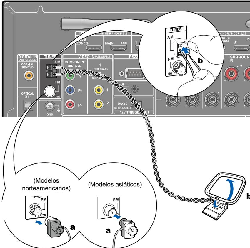
Conecte la antena a esta unidad y colóquela en una posición óptima para escuchar las señales de radio recibidas. Coloque la antena de FM para interiores en la pared con chinchetas o cinta adhesiva.
