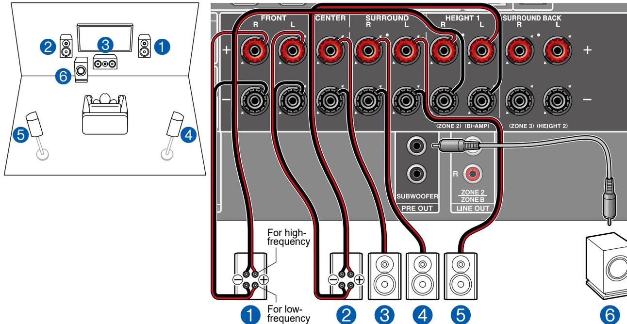
Es posible configurar un sistema de canales 5.1 (→p18) conectando altavoces delanteros que admitan la conexión de biamplicación. La conexión de biamplicación puede modificar la calidad de los rangos graves y agudos. Asegúrese de retirar el puente que conecta los conectores del woofer y los conectores del tweeter de los altavoces de biamplicación compatibles. Consulte, también, el manual de instrucciones de los altavoces.
