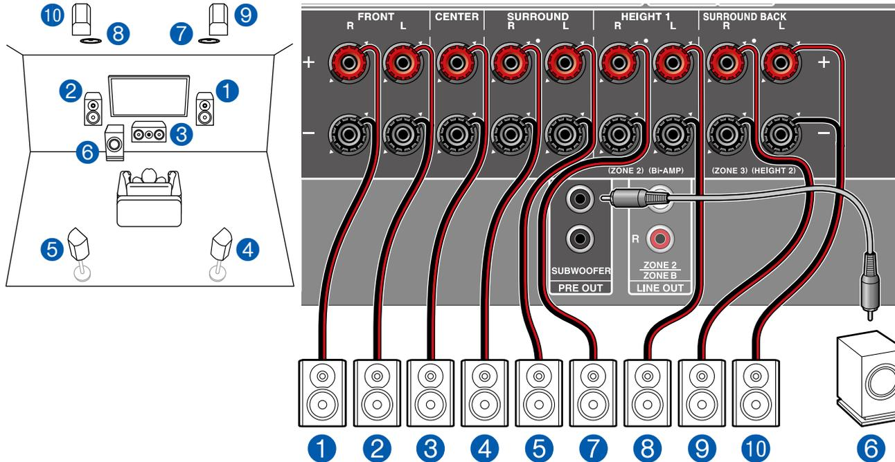
Este es un ejemplo de combinación de los altavoces medios superiores y los altavoces altos traseros y delanteros en la parte trasera del sistema de canales 5.1. Los altavoces de altura en la parte delantero se puede seleccionar de los 4 siguientes tipos. Los altavoces de altura que se pueden combinar en la parte trasera difieren en función de los altavoces de altura que se utilizan delante.
