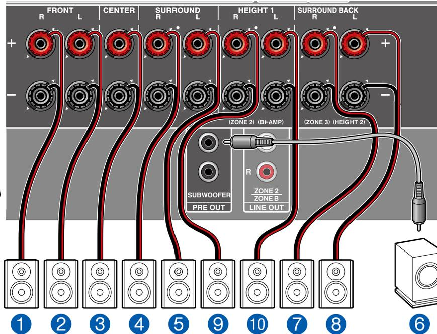
**MAIN ROOM:** Este es un sistema de canales 7.1 que incluye el sistema básico de canales 5.1 y unos altavoces envolventes traseros adicionales. Para obtener información detallada acerca de la disposición de los altavoces, consulte la "Instalación de altavoces" ( →p19).
