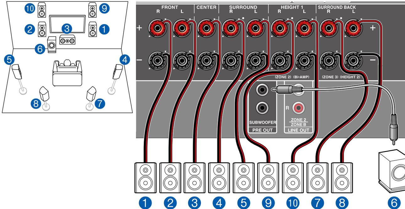
Esta es una combinación del sistema de canales 7.1 y altavoces altos delanteros. Un altavoz alto delantero es un tipo de altavoz de altura. Puede seleccionar únicamente un conjunto de altavoces de altura entre los siguientes tres tipos de conexión.
