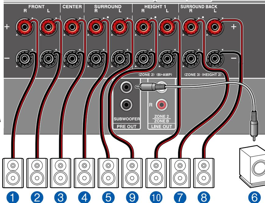
**MAIN ROOM:** Esta es una combinación del sistema de canales 5.1 y altavoces altos delanteros. Un altavoz alto delantero es un tipo de altavoz de altura. Puede seleccionar únicamente un conjunto de altavoces de altura entre los siguientes tres tipos de conexión.
