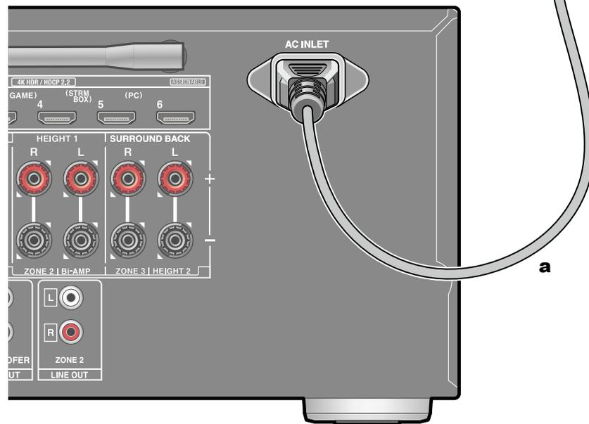
Conecte el cable de alimentación tras haber completado las otras conexiones.
