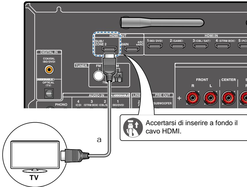
Mentre si riproduce un disco su un lettore Blu-ray Disc nella stanza principale (dove è posizionata questa unità), è possibile riprodurre video e audio dello stesso lettore Blu-ray Disc o di un altro componente AV su una TV dotata di un terminale HDMI IN in una stanza separata (ZONE 2). Notare che solo i dispositivi collegati agli ingressi HDMI da IN1 a IN3 possono essere riprodotti sul televisore nella stanza separata.
