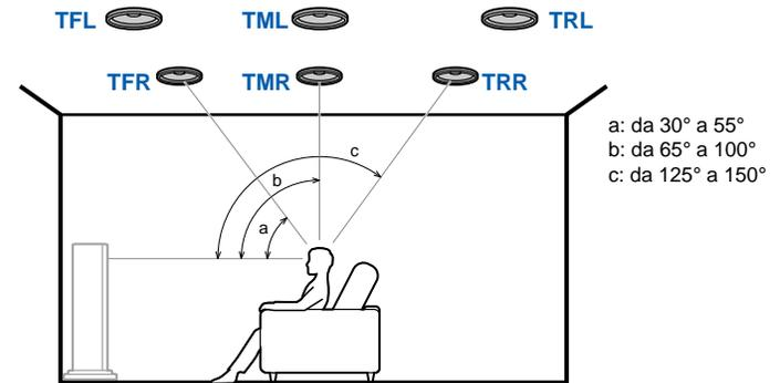
**TFL, TFR** Installare i diffusori a soffitto anteriori sul soffitto davanti alla posizione di ascolto.
