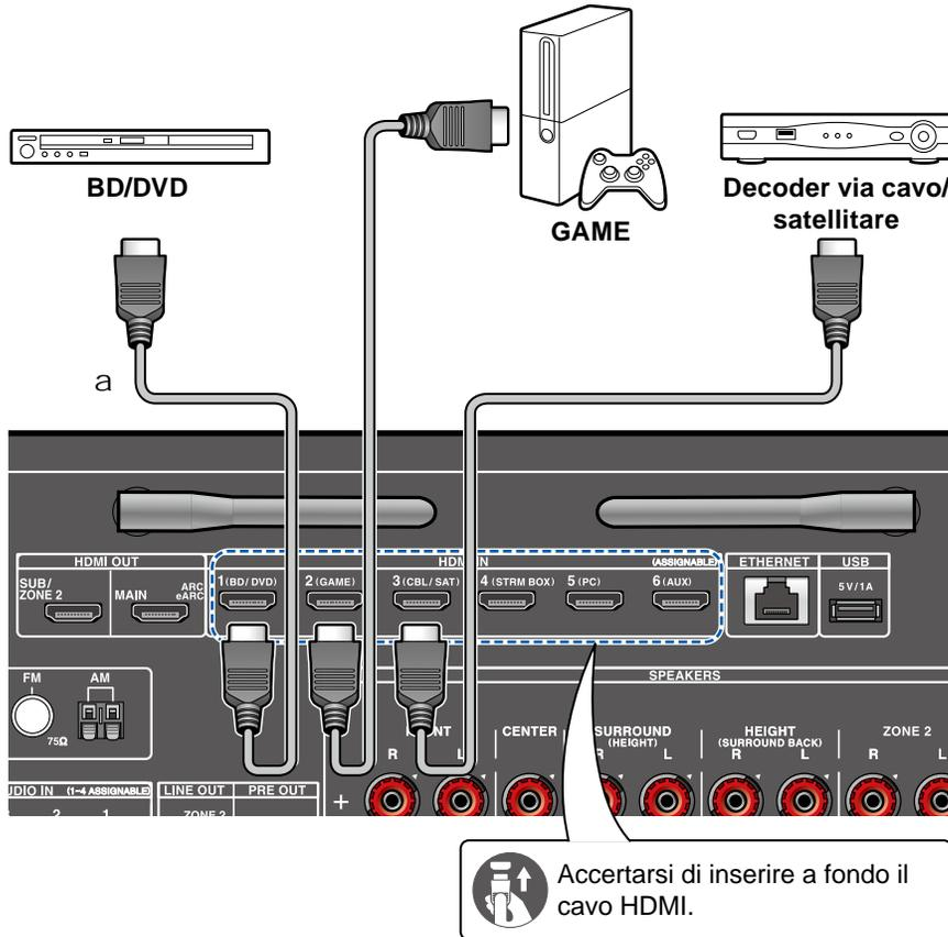
Questo è un esempio di collegamento di un componente AV munito di terminale HDMI. Se si collega l'unità a un componente AV conforme allo standard CEC (Consumer Electronics Control), è possibile utilizzare la funzione HDMI CEC (\*) che consente il collegamento con selettori di ingresso ecc., e la funzione HDMI Standby Through, che consente di trasmettere segnali video e audio dal componente AV al televisore anche quando questa unità si trova in standby.
