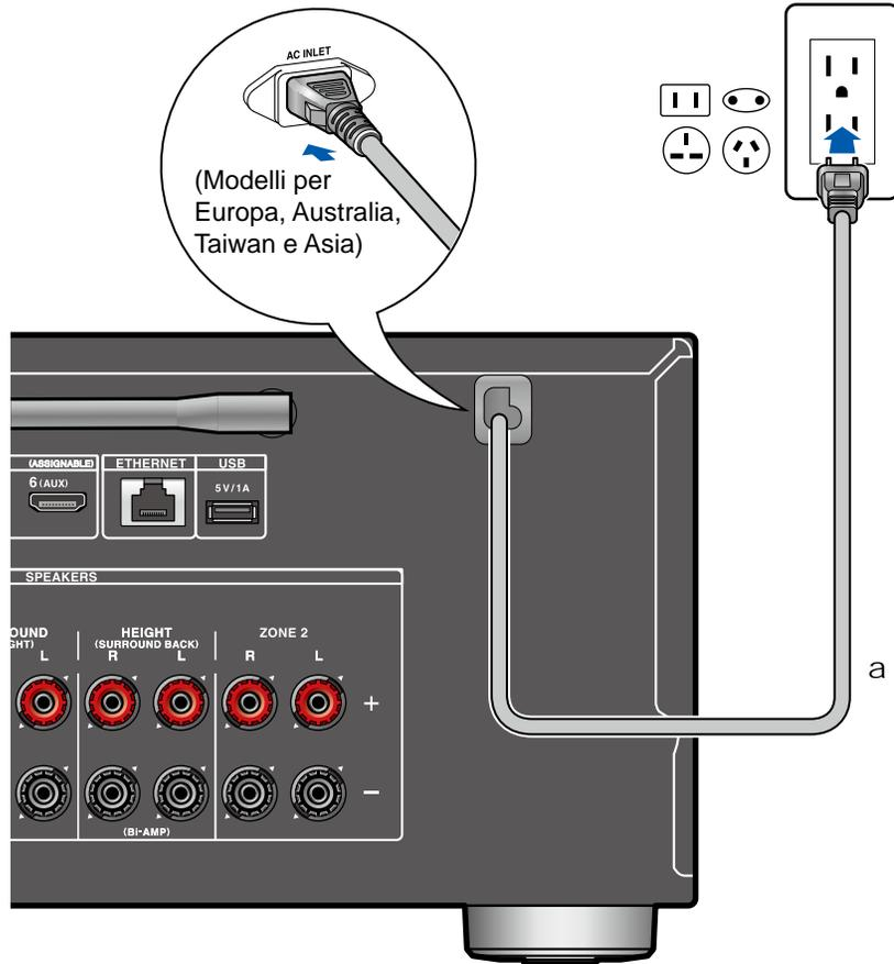
Collegare il cavo di alimentazione dopo che sono stati completati tutti i collegamenti.
