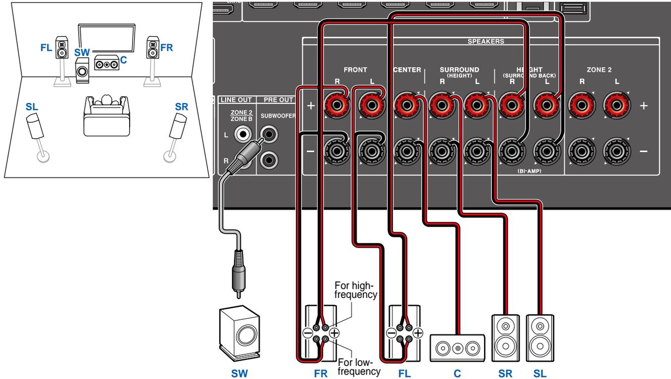
Accertarsi di rimuovere la barra dei jumper che collega i terminali del woofer ed i terminali del tweeter dei diffusori che supportano la bi-amplificazione. Fare riferimento anche al manuale di istruzioni dei diffusori in uso.
