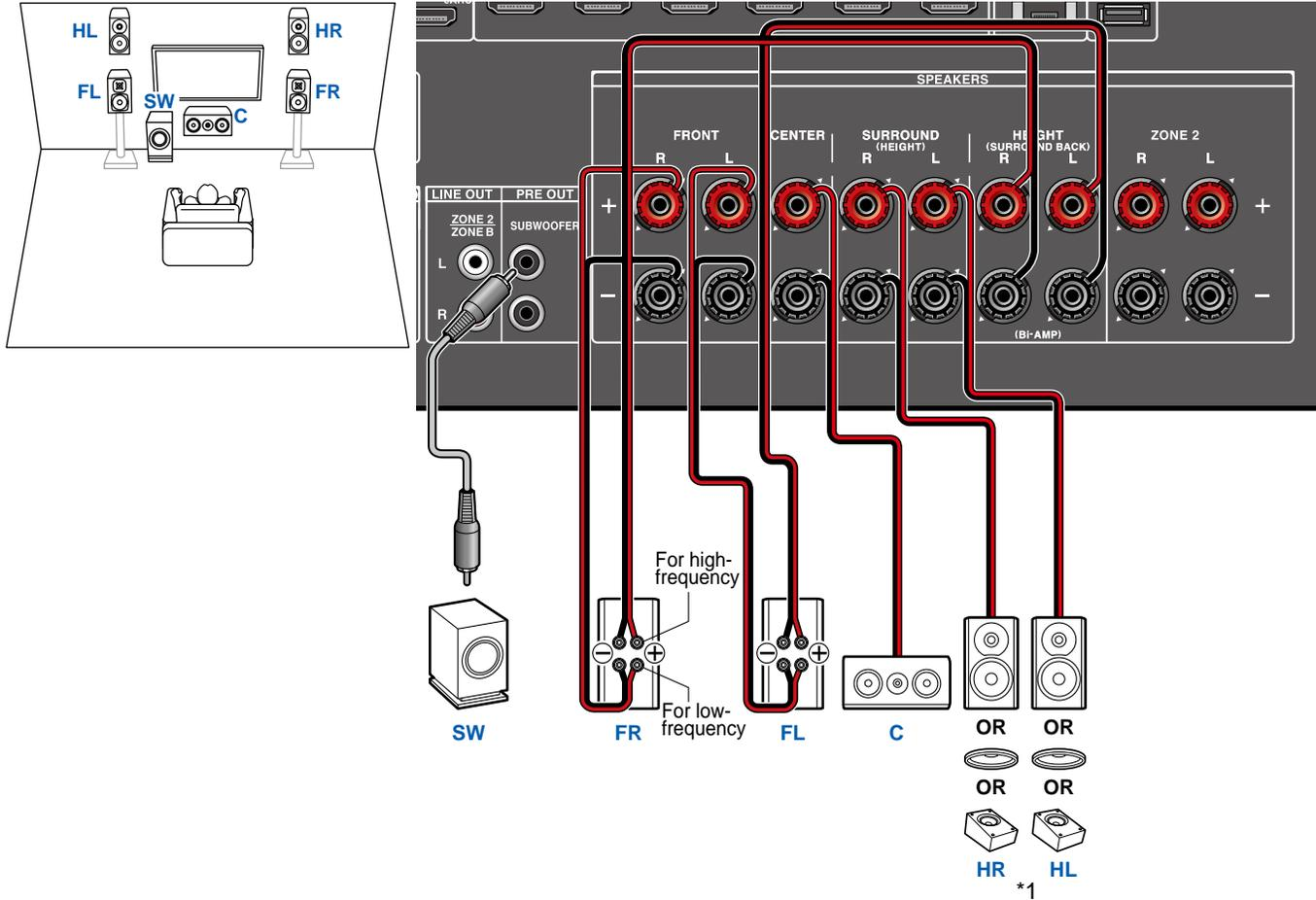
Accertarsi di rimuovere la barra dei jumper che collega i terminali del woofer ed i terminali del tweeter dei diffusori che supportano la bi-amplificazione. Fare riferimento anche al manuale di istruzioni dei diffusori in uso.
