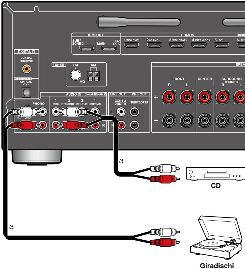
Questo è un esempio di collegamento di un componente audio. Effettuare il collegamento al lettore CD usando un cavo audio analogico. È anche possibile collegare un giradischi con testina di tipo MM al terminale PHONO.
