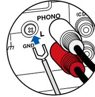
Se il giradischi ha un cavo di messa a terra, collegarlo al terminale GND di questa unità.
