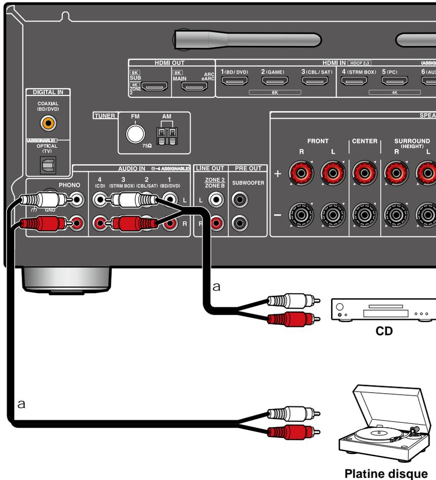
Exemple de raccordement avec un appareil audio. Raccordez un lecteur CD à l'aide d'un câble audio analogique. Vous pouvez également raccorder une platine disque possédant une cartouche de type MM à la prise PHONO.
