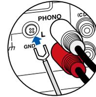
Si la platine disque a un fil de mise à terre, branchez-le à la borne GND de cet appareil.
