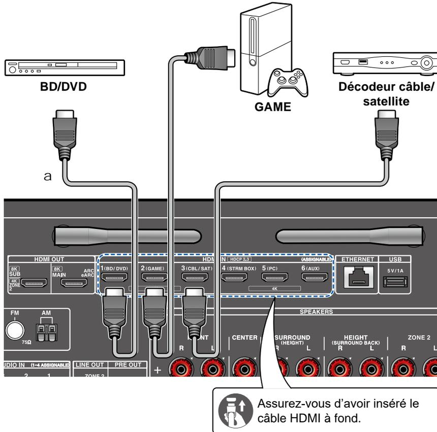
Il s'agit d'un exemple de raccordement avec un appareil AV possédant de prise HDMI. En raccordant un appareil AV conforme à la norme CEC (Consumer Electronics Control), vous pouvez utiliser la fonctionnalité HDMI CEC (\*) qui établit une liaison avec les sélecteurs d'entrée, etc. et la fonctionnalité HDMI Standby Through qui vous permet de transférer les signaux vidéo et audio provenant de l'appareil AV sur le téléviseur même si cet appareil est en veille.
