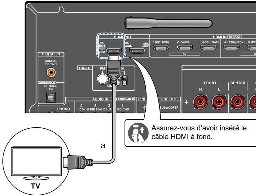
Lorsqu'un disque Blu-ray est lu dans la pièce principale (là où cet appareil est situé), vous pouvez lire l'audio et la vidéo du même lecteur de disque Blu-ray ou d'un autre appareil AV sur le téléviseur équipé d'une prise HDMI IN dans une autre pièce (ZONE 2). Il est à noter que seuls les périphériques raccordés aux prises HDMI IN1 à IN3 peuvent être lus sur le téléviseur situé dans une pièce différente.
